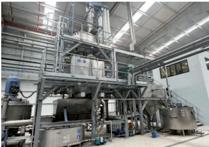
Die beiden SMS-Schneidmühlen mit Zwangsbeschickung, die in der ersten Linie installiert wurden, sorgen für eine gleichmäßige Flakegröße sowie einen stabilen Materialeintrag und schaffen damit ideale Bedingungen für nachgelagerte Wasch- und Dichtentrennprozesse (Fotos: Herbold Meckesheim)
