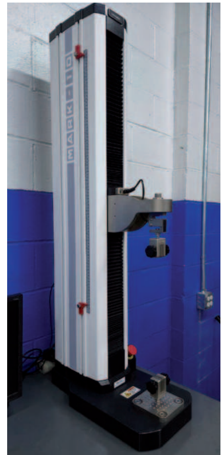
Zugtestanlage in der Extrusionsanlage
