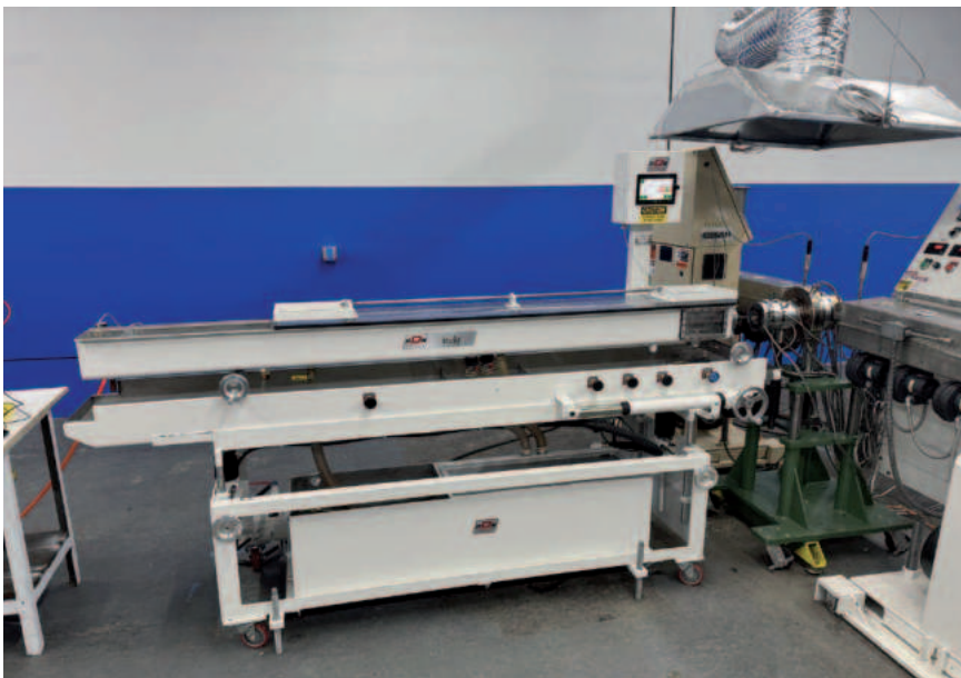
Fluidisiertes Bad in der Test-Extrusionsanlage
