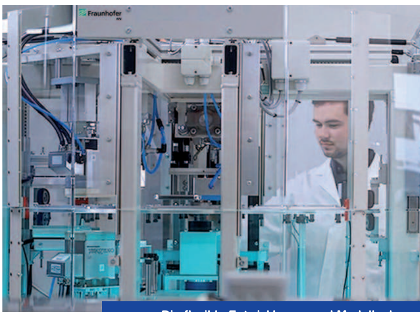
Die flexible Entwicklungs- und Modellanlage "MoTiV" ermöglicht die Verarbeitung neuer Rezyklatmaterialien und Prototyping ab Stückzahl 1 (Alle Bilder © Fraunhofer IVV)
